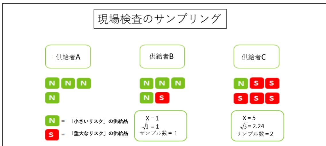
図 12 の例示においては、CoC 管理事業体は供給者 B 及び供給者 C について現場検査を実行する。供給者 B における現場検査は一つの特定期間供給品について実行するのに対し、供給者 C においては二つの供給品について検査を実行する。
